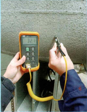
照片說明：將保溫塗料噴塗在儲槽外部，儲槽內部溫度平均在50°C以上，使用保溫塗料後，外部表面測得溫度僅有32°C，達到保護儲槽內部材料的目的
