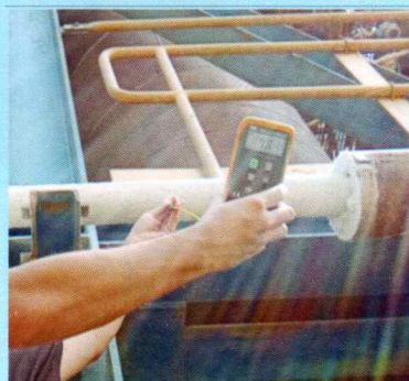
照片說明：尚未噴塗保溫塗料的管線量測到溫度約為102°C(左圖)，使用保溫塗料之後測得溫度降至78度°C(右圖)。
