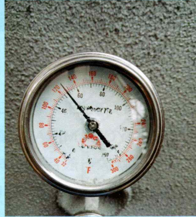
照片說明：將保溫塗料噴塗在儲槽外部，儲槽內部溫度平均在50°C以上，使用保溫塗料後，外部表面測得溫度僅有32°C，達到保護儲槽內部材料的目的
